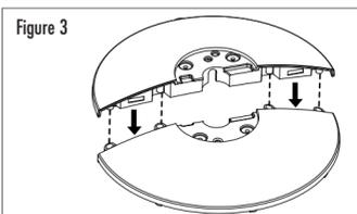
L'appareil, commencez par vous assurer que le côté marqué «Rear» est orienté vers l'arrière du radiateur. Faites concorder les trous du du socle avec ceux de la partie inférieure du pied (ou du boîtier si le radiateur n'a pas de pied), puis immobilisez-les avec les 4 vis fournies à cet effet. Voyez la figure 4.
